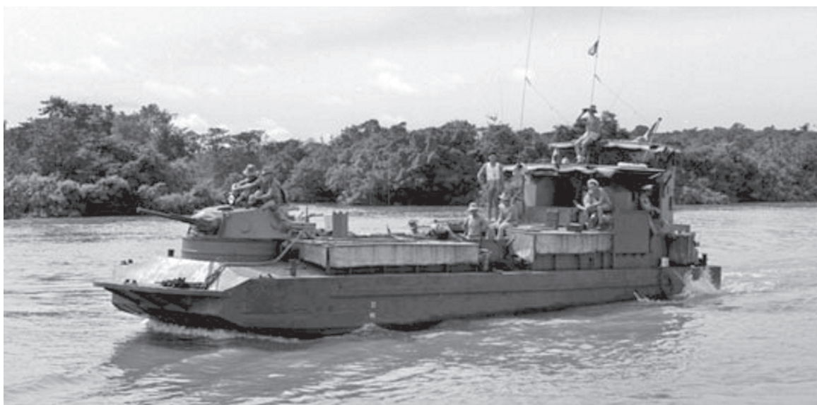
Kuter desantowy LCM przebudowany na rzeczny monitor. Na dziobie wieża z samochodu pancernego Coventry (z 40 mm armatą sprzężoną z armatą 20 mm), w ładowni 81 mm moździerz. Uzbrojenie dopełniają trzy 20 mm armaty, źródło: Marine Nationale.
