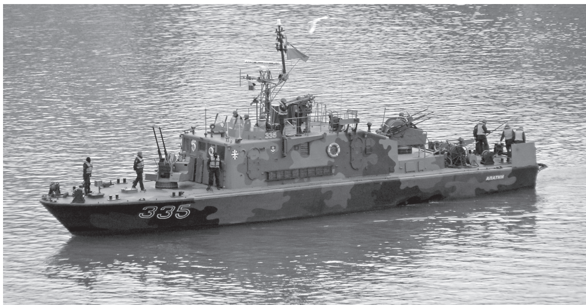
Trałowiec rzeczny Apatin typu 331. Jako jedyna jednostka w typie otrzymała na dziobie podwójnie sprzężoną armatę kalibru 20 mm.
