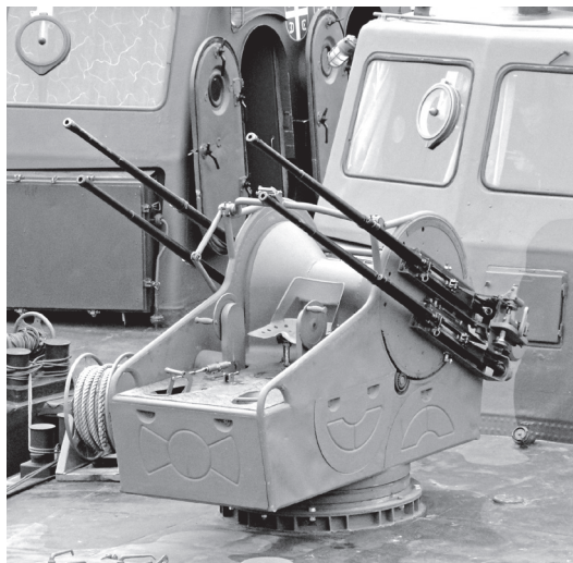
Poczwórną sprzężoną 20 mm armatę M-75/IV. Przyrządy celownicze (optyczne) zostały zdjęte (K. Kubiak).
