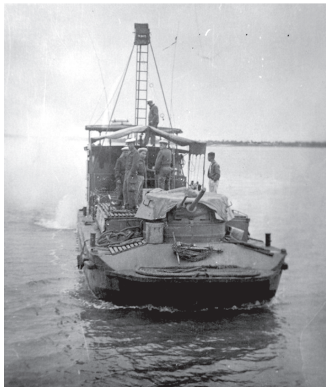
LCM 6 zaadaptowany na monitor - jednostkę dowodzenia. Dobrze widoczna wieża zdemontowana z samochodu pancernego typu Coventry, źródło: Fuerza Ribereña.
