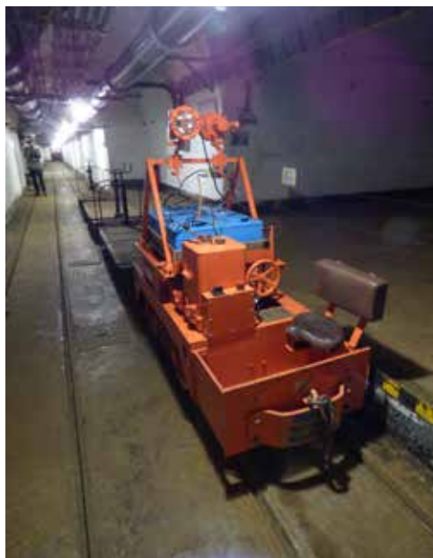
System transportu materiałów i broni chodnikiem łączącym magazyny kilku ciężkich umocnień, foto S. Januszewski
