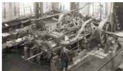
Maszyna parowa potrójnego rozprężania dla holownika tylnokołowego
