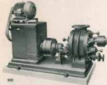
Abb. 6. Schwingkolben-Pumpe für breiige und zähe Flüssigkeiten, wie Syrup, Melasse, Maische u. dergl.
