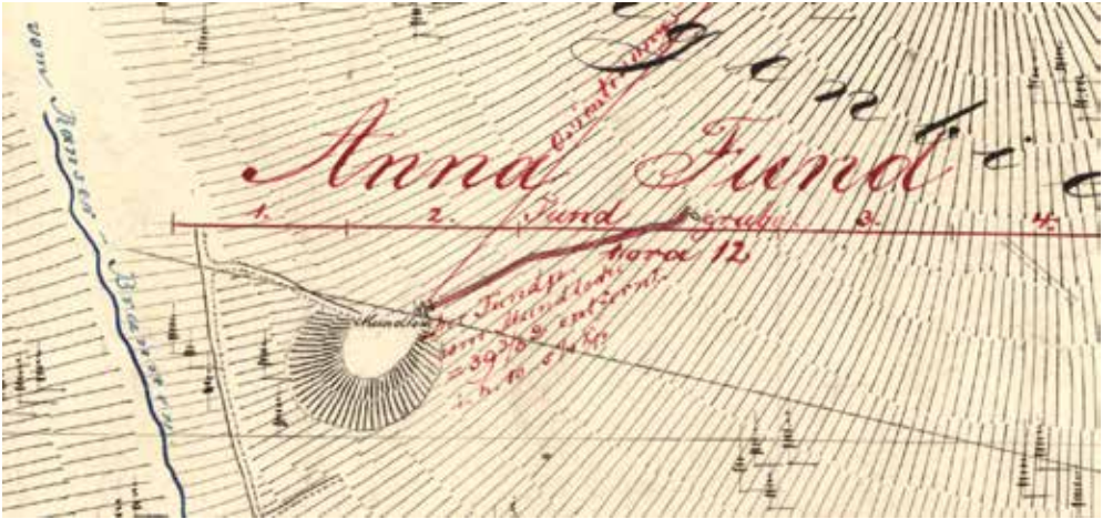
Fragment mapy „Anna Fundgrube” z 1861 r. Na powiększonym fragmencie widoczna jest warpa oraz wlot do sztolni. W 2005 r. udało się zlokalizować, odkopać i spenetrować wyrobisko.
