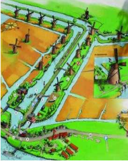
System przerzutowy wody z polderów do kanałów i dalej do rzeki Lek
