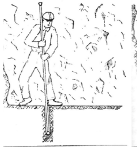
Ryc. 006. Wiercenie ręczne otworu strzałowego „loską”
