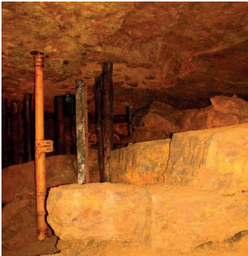
Rys. 5. Obudowa stalowa indywidualna podpierająca warstwę stropowe
