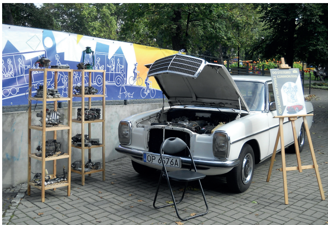
Plenerowa ekspozycja samochodowych urządzeń paliwowych: gaźników, reduktorów LPG, benzynowych urządzeń wtryskowych oraz urządzeń wtryskowych oleju napędowego. Obok – samochód Mercedes-Benz W114 z dwoma dwustopniowymi gaźnikami Zenith
