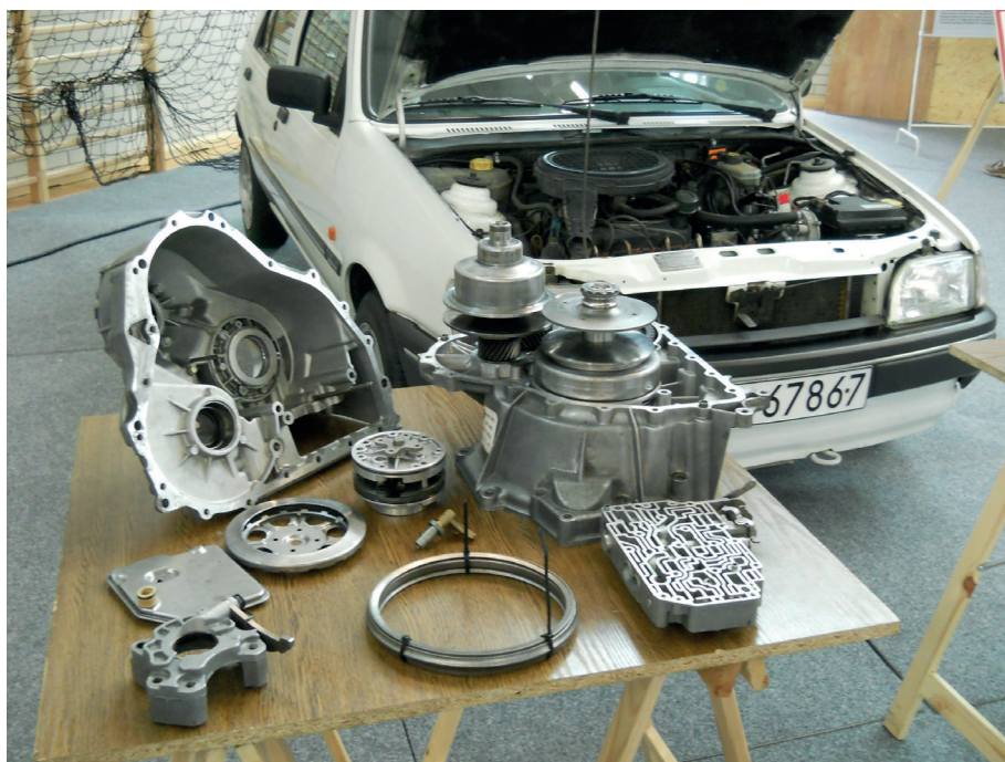
Prezentacja samochodu Ford Fiesta wraz z elementami automatycznej przekładni pasowej CTX
