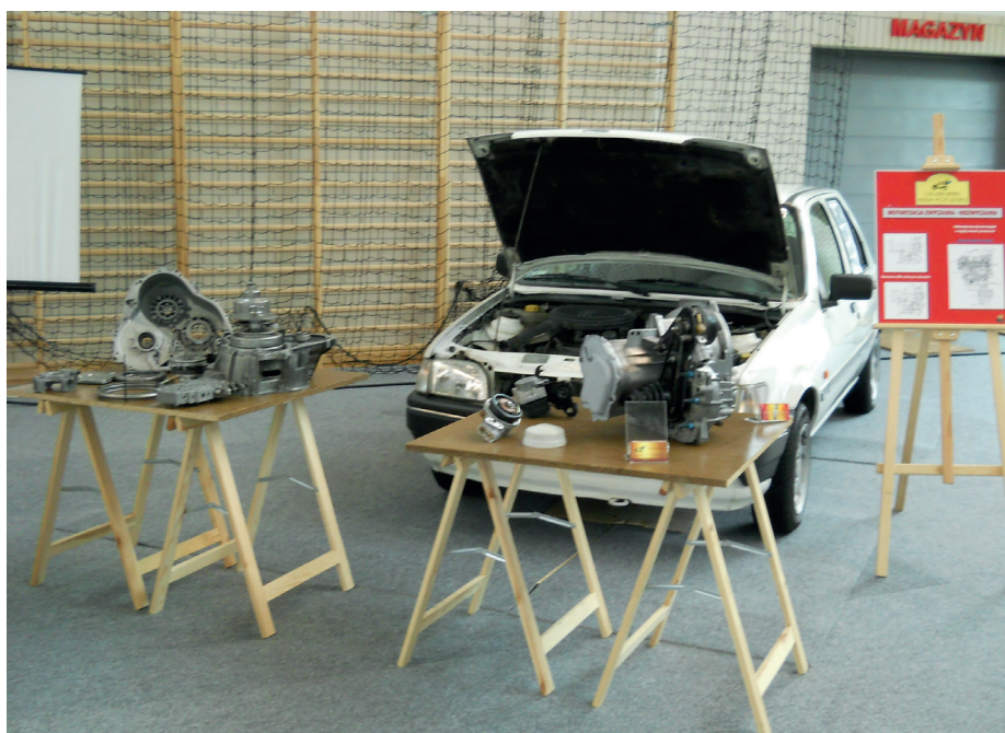
Plenerowa prezentacja samochodu Volvo 340 wraz z elementami oryginalnej automatycznej przekładni pasowej Variomatic
