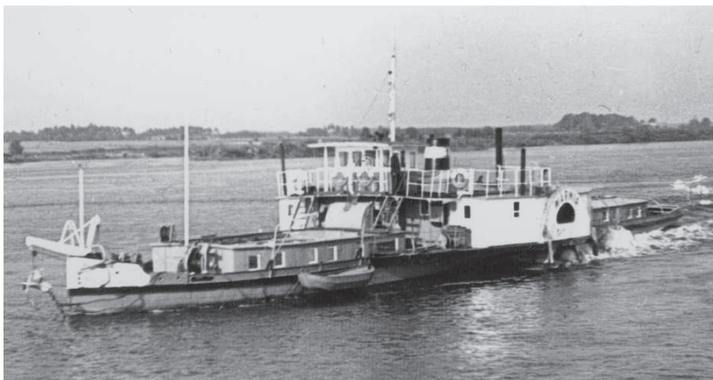
WARMIA ex LUBECKI ex POLAK 1912 na Wiśle pod Karolewem 1968, (statek miał początkowo silnik niskoprężny z samoczynnym zapłonem, na naftę, konstrukcji Nobla)
