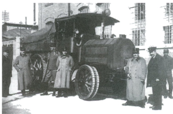
Próba obciążenia (1917) ciągnika Ferdinanda Porsche, którego koła opatrzone patentowanymi przez Augusta Warchałowskiego (stoi z prawej) obręczami sprężystymi, album fotografii z kolekcji Anny Warchałowskiej.
