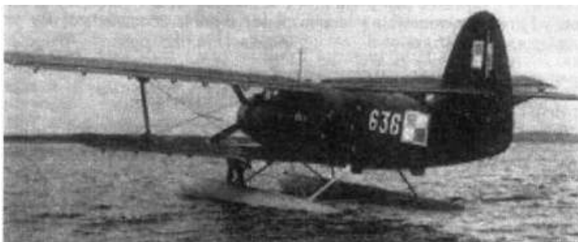
Samolot An-2M na podwoziu pływakowym przeznaczony do eksploatacji na rzekach, jeziorach oraz przybrzeżnych rejonach morskich. Posiadał mały rozbieg i dobieg oraz łatwą obsługę, co pozwalało na eksploatację samolotu na niewielkich zbiornikach wodnych, bez wyposażonych baz. An-2M był budowany na bazie samolotu transportowego. Samolot w tej wersji zbudowano w niewielkiej liczbie-prawdopodobnie 12 egz., źródło: http://www.pilot.net i http://wikipedia.org .
