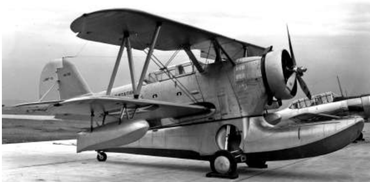
Samolot morski Grumman JF-2 „Duck” z chowanym podwoziem według patentu US 1,859,624 Retractable landing gear for airpanes.
