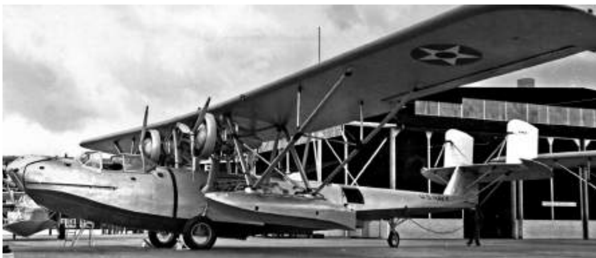
Consolidated P2Y na podwoziu ręcznym według patentu US 2,227,725 Aircraft handling gear.
