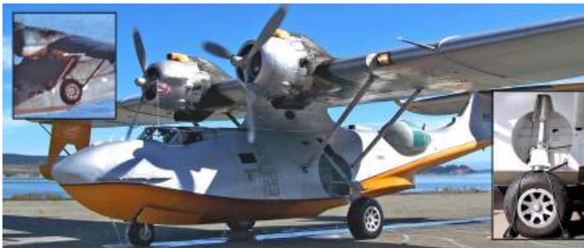
Consolidated PBY-5A „Catalina” z widocznym podwoziem kołowym opracowanym według patentu Grummana US 1,859,624 Retractable landing gear for airpanes.
