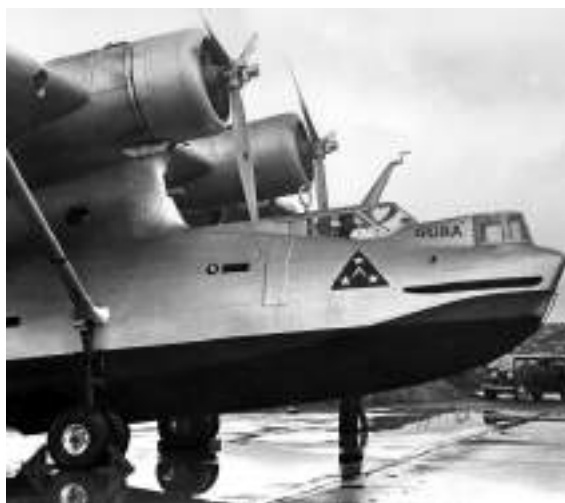
Starsza odmiana PBY „Catalina” z dołączonym ręcznie podwoziem według patentu US 2,227,725 Aircraft handling gear.
