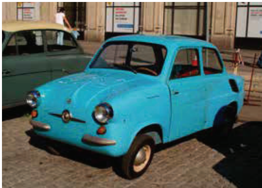
Mikrosamochód Mikrus MR-300 ze zbiorów Muzeum Inżynierii Miejskiej, stan przed renowacją. W momencie pozyskania przez muzeum, pojazd posiadał szereg nieoryginalnych elementów zaadaptowanych z innych samochodów, min. skody octavii super oraz nysy 521, foto I. Wachowicz
