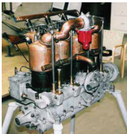
Silnik „Austro - Daimler”, czterocylindrowy 65 KM, typu stosowanego na samolocie „Warchałowski” typu II bis, kolekcja Muzeum Techniki w Wiedniu, foto. autor.
