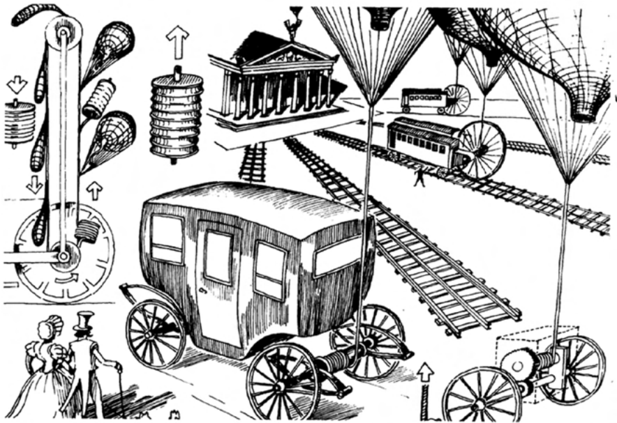
Balon jako silnik i jego różne połączenia z pojazdem czy wyciągarką oraz układ balonu próżniowego pracującego na linii bez końca w cyklu: rozciągnięcie powłoki – wypompowanie powietrza – wzlot a po osiągnięciu pułapu: otwarcie kłapy – wyrównanie ciśnienia wewnętrznego z atmosferycznym – złożenie powłoki – opuszczenie w dół, po czym następuje kolejny cykl roboczy. Na podstawie rysunków zawartych w patencie i w dodatku oprac. Stanisław Januszewski, rys. Ernest Niemczyk.
