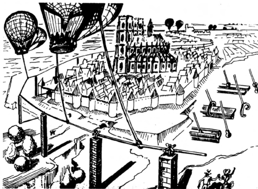
Kolej balonowa – system przemieszczania balonu komunikacyjnego względem ziemi; torowisko napowietrzne i sprzęgła łączące z nim balon wleczony (w różnych wersjach). Opracował S. Januszewski na podstawie oryginalnych rysunków z memoriału patentowego, rys. Ernest Niemczyk.
