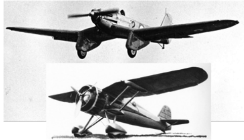
Rys. 29. Brytyjski Supermarine Type 224 (daleki protoplasta Spitfire) w układzie dolnopłata z odwróconą mewą oraz przewyższający go wieloma osiągami polski PZL P.24/II, na którym 28 czerwca 1934 r. Bolesław Orliński ustanowił rekord prędkości dla samolotów myśliwskich z silnikiem gwiazdowym, osiągając 414 km/h.
