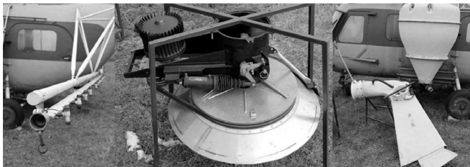
Rura opryskowa, rozsiewacz tarczowy (odśrodkowy), zbiornik chemikaliów i rozsiewacz tunelowy ( http://agrolotnictwo.muzeumlotnictwa.pl )
