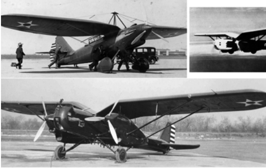
Rys. 19. Amerykański samolot obserwacyjny Douglas O-31 z 1930 r. (u góry) oraz dwusilnikowy bombowo-obszerny z chowanym podwoziem Douglas B-7 (O-35) z 1931 r.
