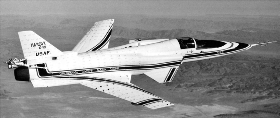
Rys. 37. Samolot eksperymentalny Grumman X-29 z 1984 r., którego przednia część kadłuba wraz z podwoziem przednim pochodzi z myśliwca F-5 Freedom Fighter, silnik od F/A-18 Hornet, a podwozie główne od F-16 Fighting Falcon. Z rysunków wynika, że to właśnie na nim zamierzano oprzeć patent US 5,542,625, lecz ostatecznie go nie zrealizowano.
