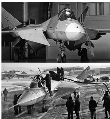
PAK FA z wychylonym w dół usterzeniem przednim – na dole prototyp T-50, u góry seryjny Su-57. Uwagę zwraca także płytowe usterzenie pionowe
