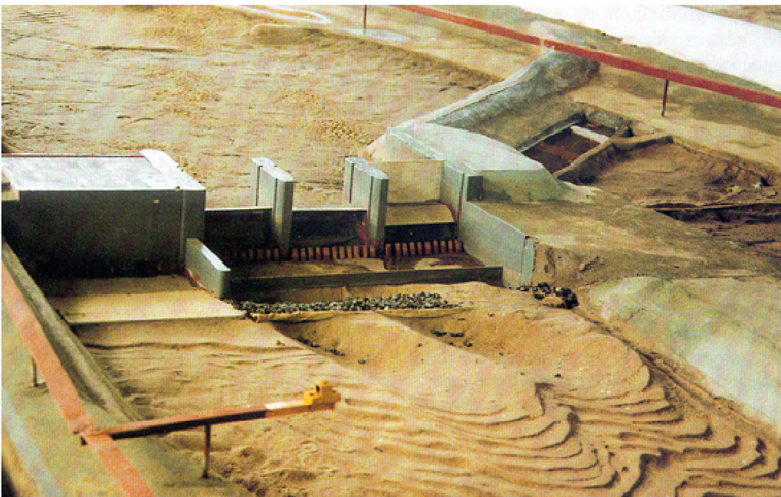
Badania modelowe stopnia wodnego Malczyce w Laboratorium Hydrotechnicznym Politechniki Wrocławskiej (poniżej jazu widoczny wybój i tworząca się erozja denna spowodowana energią wody).
