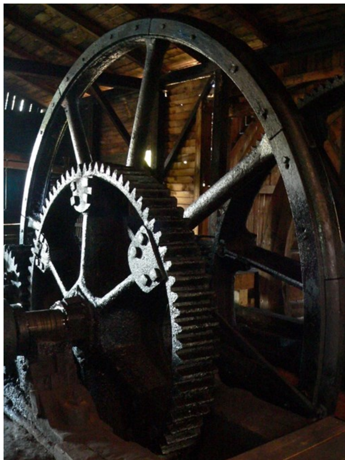
Koło zamachowe napędzające walcownię i gwoździarnię, fot M.K. Misztal
