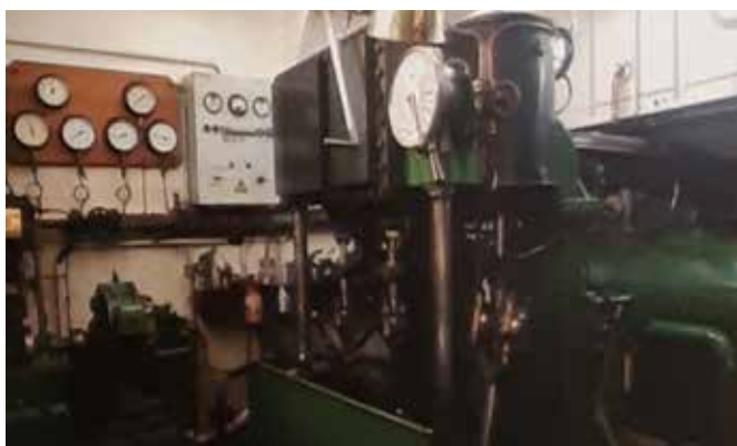
Dwucylindrowy silnik parowy statku.
