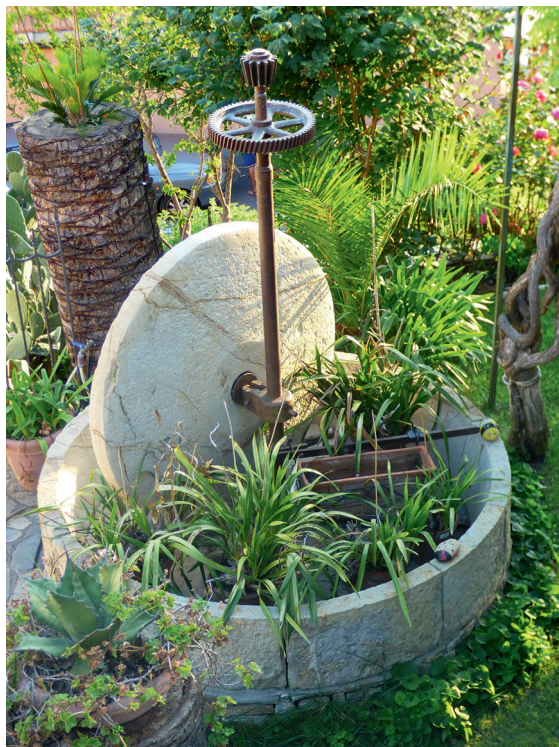
Gniotownik z mechanicznymi przekładniami napędu, Diano Castello (Liguria), Włochy, S. Januszewski
