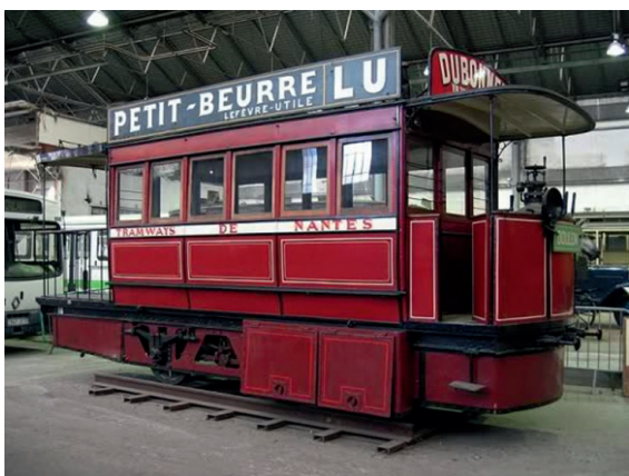
Tramwaj (1879) z napędem z silnika pneumatycznego syst. Ludwika Męcarskiego, z kolekcji Muzeum Transportu Miejskiego w Chelles k/Paryża.
